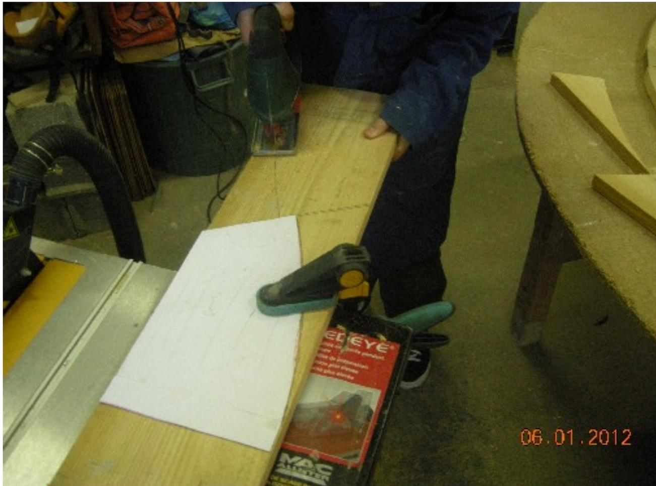
Débit de la 1<sup>ère</sup> roue avec l'aperçu de la maquette posée sur un contreplaqué qui permettra de relier les 12 rayons de la roue.
