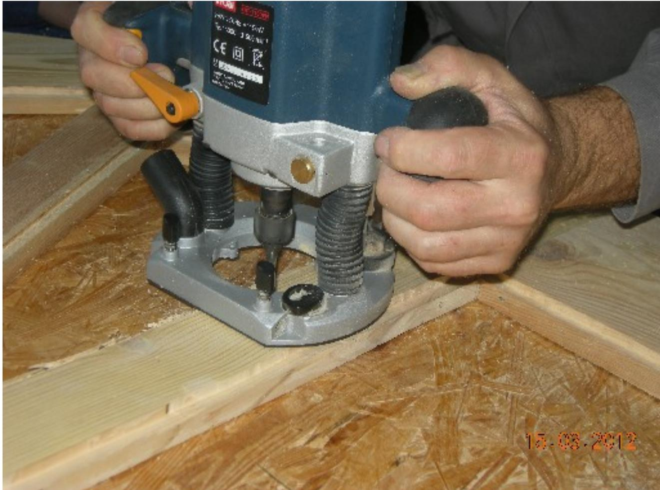
Mise en place des lamelles dans les emplacements réalisés avec la lamelleuse. Assemblage de deux pièces de bois: un rayon et une pièce posée à angle droit qui les relie.
