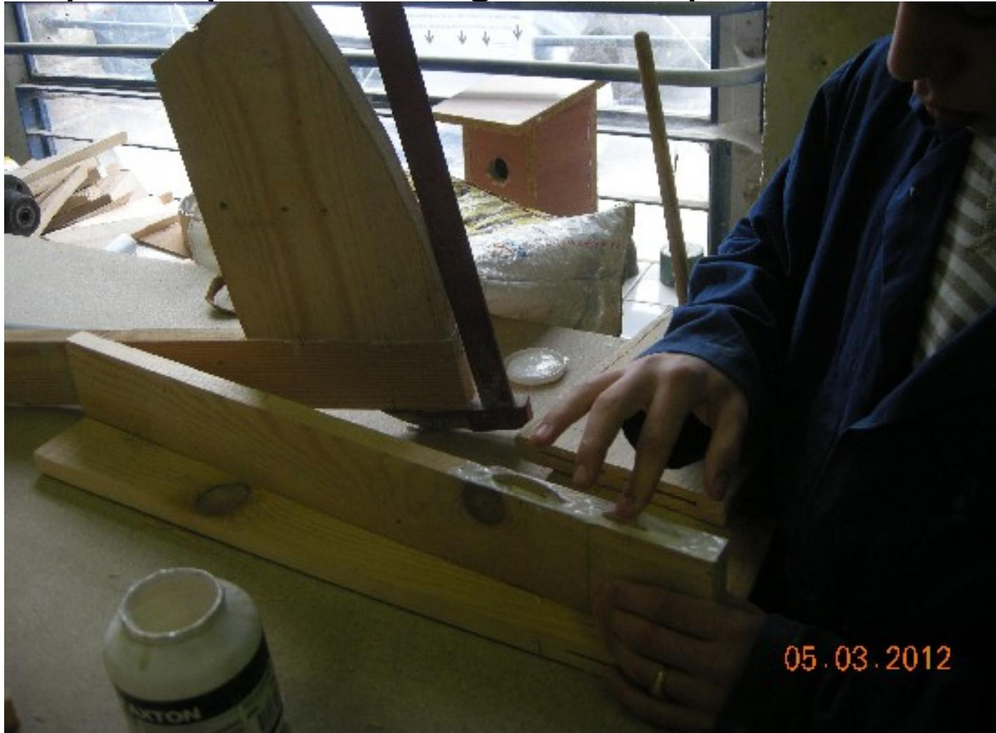
Cerclage d'une roue lors du séchage de la colle, utilisation une corde tendue par un bout de fer à béton maintenu avec des pointes .
