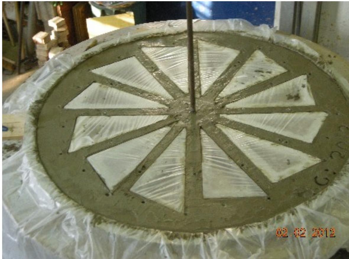
Tracé de l'emplacement des lamelles qui permettront l'assemblage des pièces de bois.
